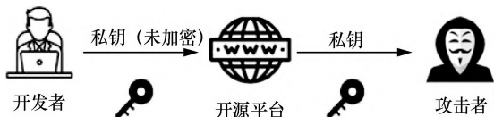
图 5 私钥泄露威胁模型 Figure 5 Private key leakage threat model
